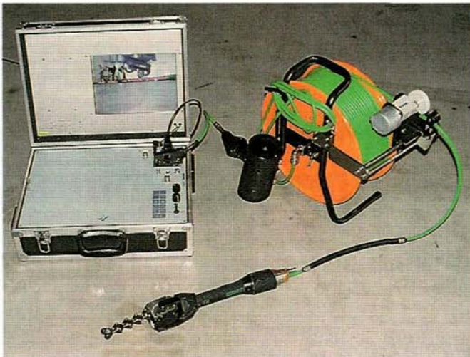
Abb. 3: Mobile Inspektionseinheit für den Schiebetrieb
